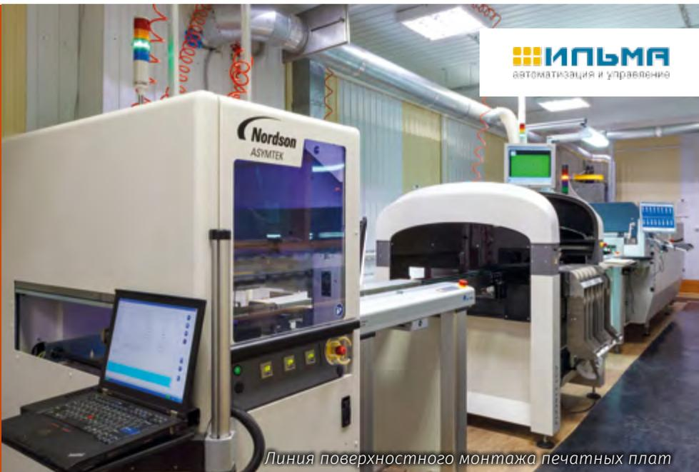
Линия поверхностного монтажа печатных плат
