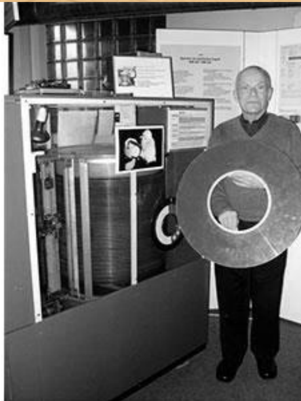
Диск IBM 350 в составе компьютера IBM 305 RAMAC
